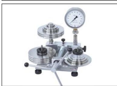
**Calibrador de un censo con un manómetro de precisión - F4**
